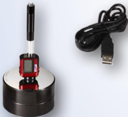
L'HRP300 viene fornito con una sonda d'impatto più avanzata. A differenza dei precedenti modelli il display è integrato nel sensore d'impatto, è quindi privo di cavi. È possibile la comunicazione USB con un PC tramite il software incluso.
