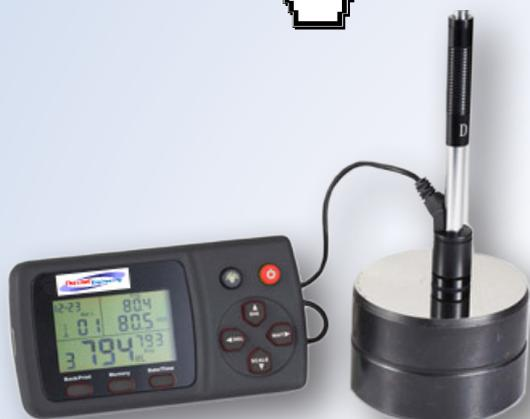
L'HRT900 è un durometro ad impatto basato sul principio di durezza della scala Leeb. Di dimensioni compatte, leggero e semplice da utilizzare.
